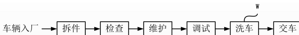
图2 项目汽车维护流程图
